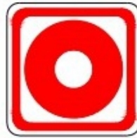
PULSADOR DE ALARMA
